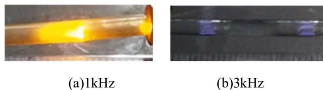
図3 スラグ流路内におけるプラズマ発光の様子
