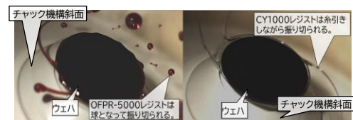
図 2. ハイスピードカメラで撮影したレジスト振り切りの様子
