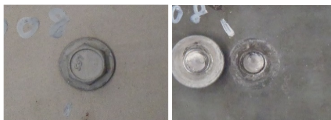
写真 1 めねじの破壊
