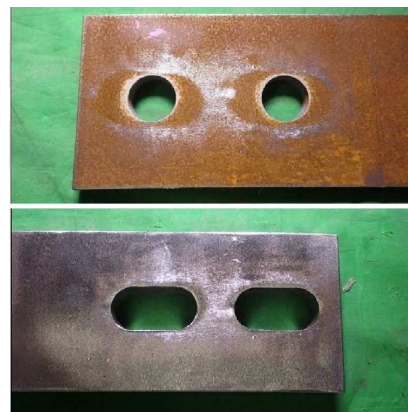
写真-2 すべり面（試験後）
