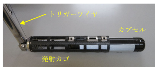
図-2 発射カゴと発射されたカプセル
