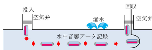
図-1 漏水位置探査技術の概要
