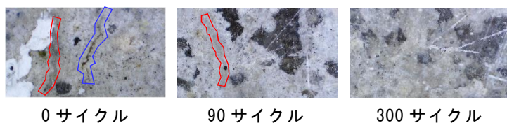
図 2 ひび割れ観察結果の一例 (PCM) Fig.2 An example of crack observation results (PCM)
