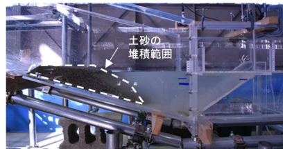
Fig.4 実験終了後の土砂の堆積状況 上: Case1-2, 下: Case5-2 Sediment deposition condition
