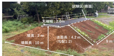
図 3 実物大堤防模型
