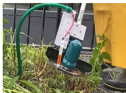
写真1 刈払機に接続したパルス重畳装置と作業状況 Connected to the brush cutter Pulse superposition device and work status
