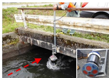
写真 3 ADCP の観測状況 Photo 3 Measurement Situation Using ADCP
