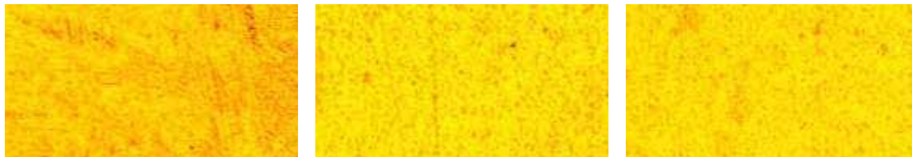
図5 拭き取り布損傷試験による漆表面光学顕微鏡写真 (左: 綿布拭き 中: スポンジ拭き 右: マイクロファイバー拭き)
