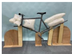
図6. 実寸モデルによる荷物積載検証
