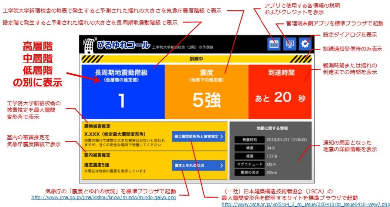
図2 「びるゆれコール」プロトタイプクライアントアプリ画面 (タブレット端末: 予測値受信時)
