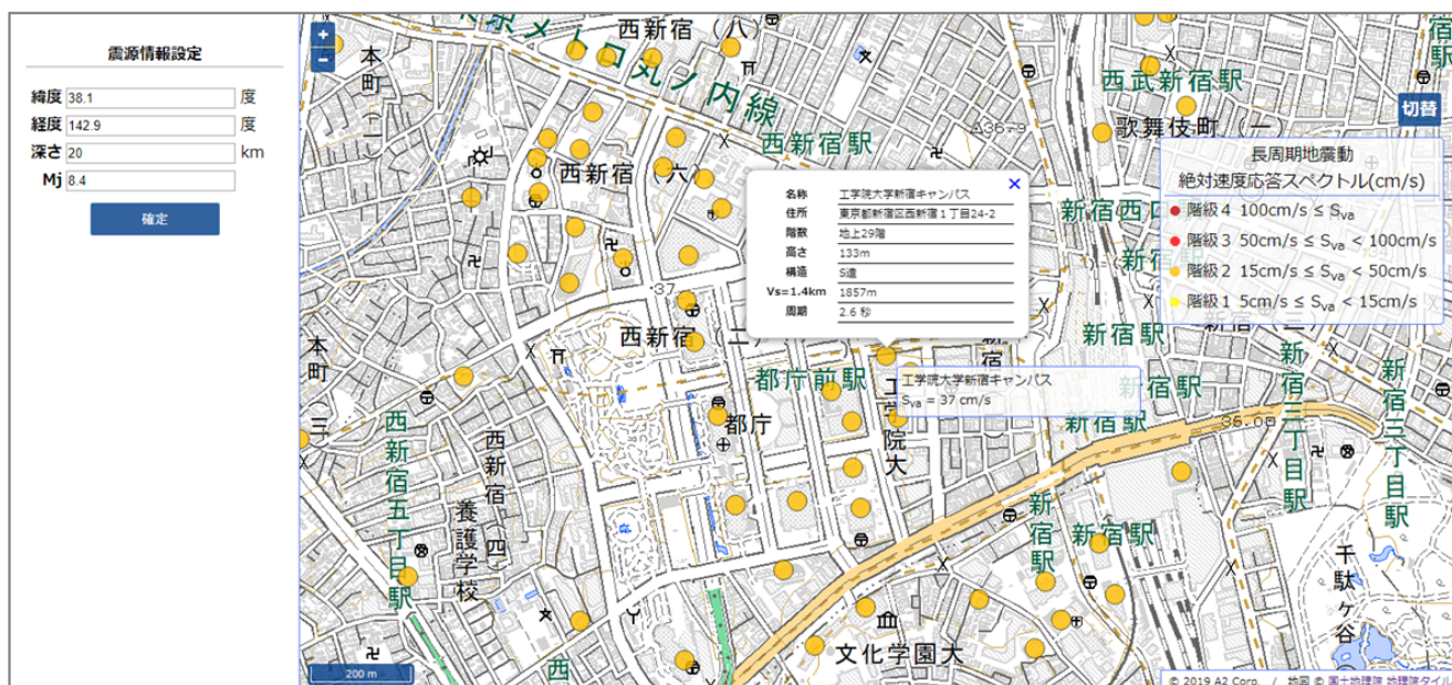
図2：周期別階級表示ツール画面。色つきの円はビルの位置と周期別階級を示す。 マウスオーバーでビルの固有周期における絶対速度応答を、 クリックでビルの基礎情報をポップアップ表示する。 地図は地理院タイル( https://www.gsi.go.jp/LAW/2930-index.html )を使用。
