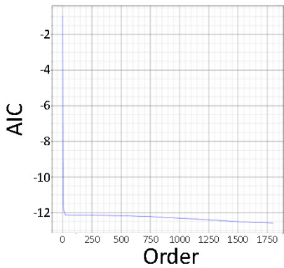
図2. ARモデル推定に使用する次数とAICの関係 次数が大きいくほどAICが小さくなる。(2002/11/17のイベントのS波20秒間のNS成分を使用。サンプリングレートは200Hz、サンプル数は4000。)
