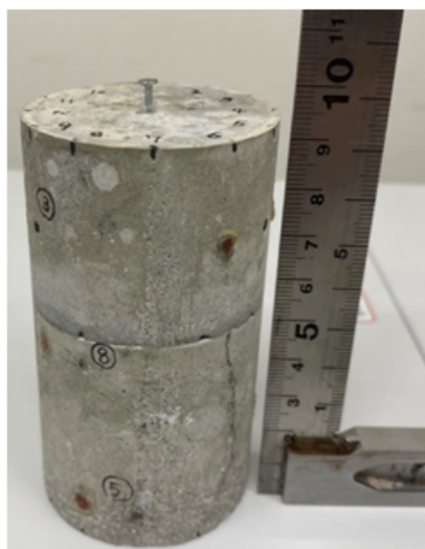
写真2 モルタルで作成した円筒形試料
