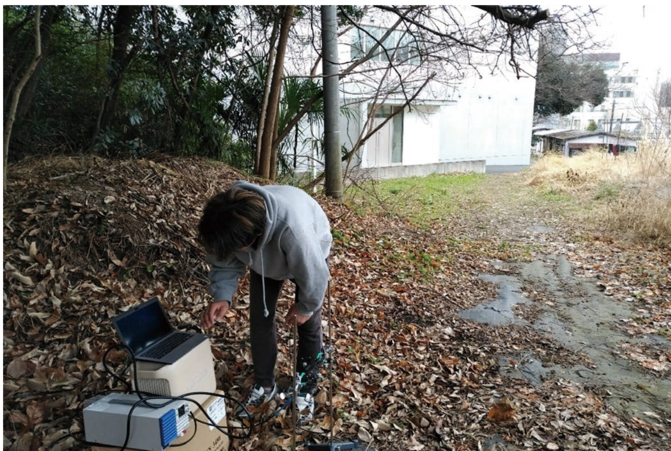
図1. 環境大気に含まれる浮遊細菌の捕集実験の様子
