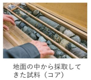
採取してきた試料をもとに、地盤の解析や判定、評価を行います。土の物理的特性や力学的性質を調べたり、岩盤の性質や粒度、硬度などを専門の機器を使って解析したりなど、さまざまな観点から地質情報を得て、報告書を作成しています。
