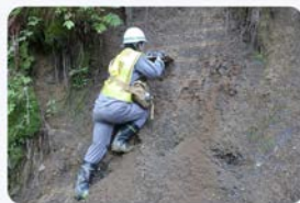
走向・傾斜の測定状況
