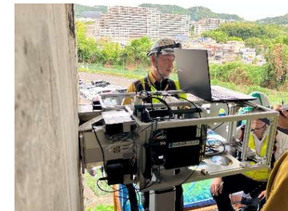
中性子線：RANS-μ （3深度の塩化物イオン濃度を測定）
